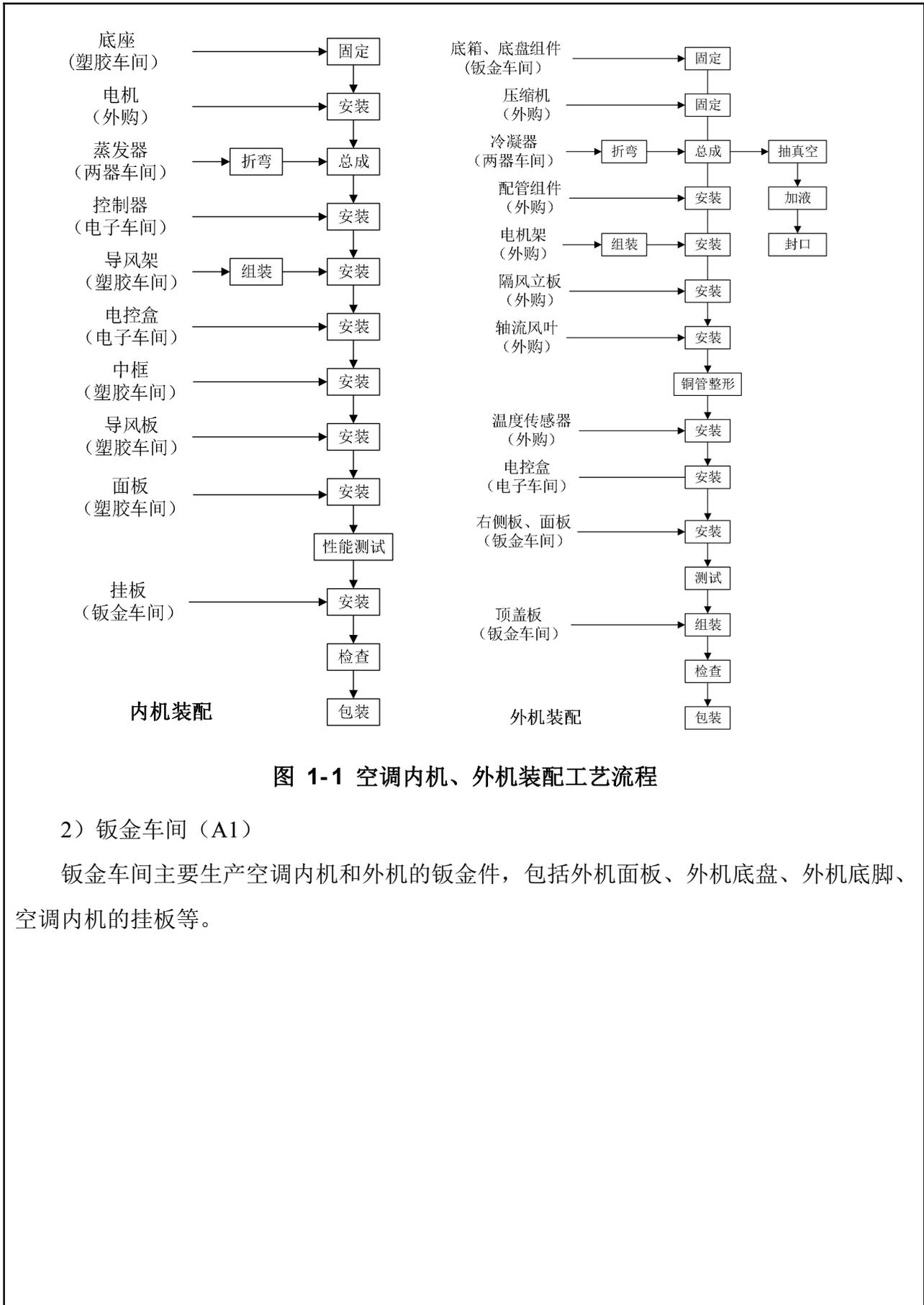
图 1-1 空调内机、外机装配工艺流程
